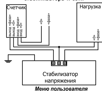
Рекомендуемая схема подключения стабилизатора к сети
