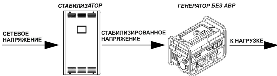
Рисунок 8 - Конфигурация 2 (размещение стабилизатора перед генератором)
