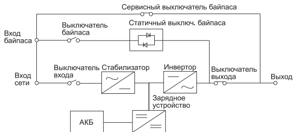
Рисунок 10 – Схема работы ИБП в режиме технического ремонта
