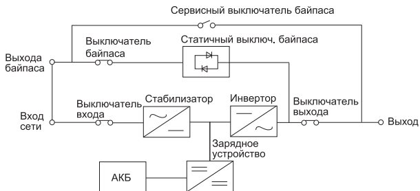
Рисунок 7 – Схема работы ИБП в стандартном режиме
