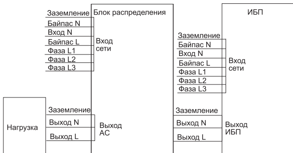
Рисунок 14 – Схема подключения с трехфазным входом и однофазным выходом
