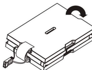
Рисунок 9. Порядок сборки комплекта из трех батарей.
