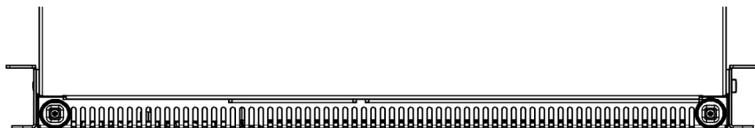
Рисунок 14. Винты фиксации передней панели у ИБП Штиль STR300SL и STR300SL-27 (расположение винтов фиксации у ИБП Штиль STR500SL и STR500SL-18 аналогично)
